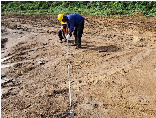
Gambar: Pengukuran Erosi Metode Benang (EksTPn)
